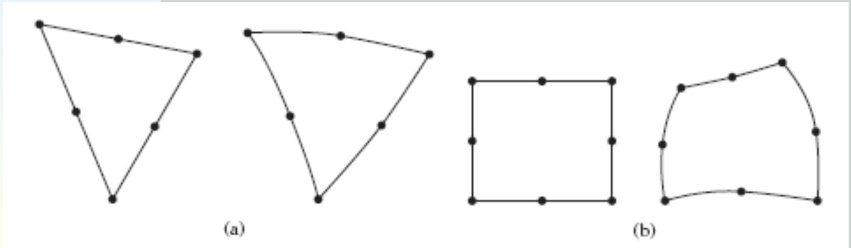
Élément isoparamétrique quadratique avec élément de base
